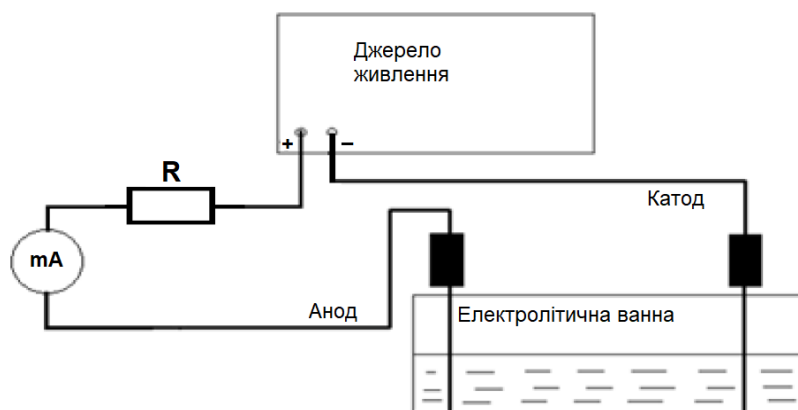
Рис. 1. Схема установки для анодування танталу
