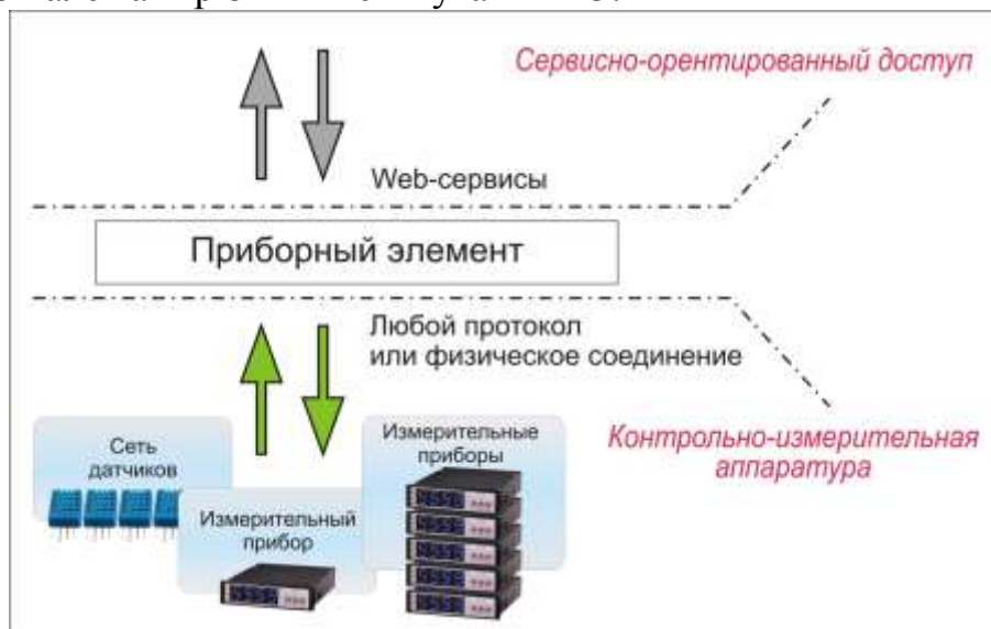
Рис.2. Схема інтеграції приладу в Грід
