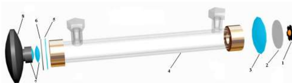
Рис.3. Оптична схема поляриметра. 1-світлодіод EDSA-1LA3; 2,6-поляризаційна плівка; 3-фокусуєча лінза; 4-кювета; 5-полікарбонатна пластина, 7-оптична система, 8- CMOS веб-камера Megapixel 10x Digital Zoom f=3.85mm.
